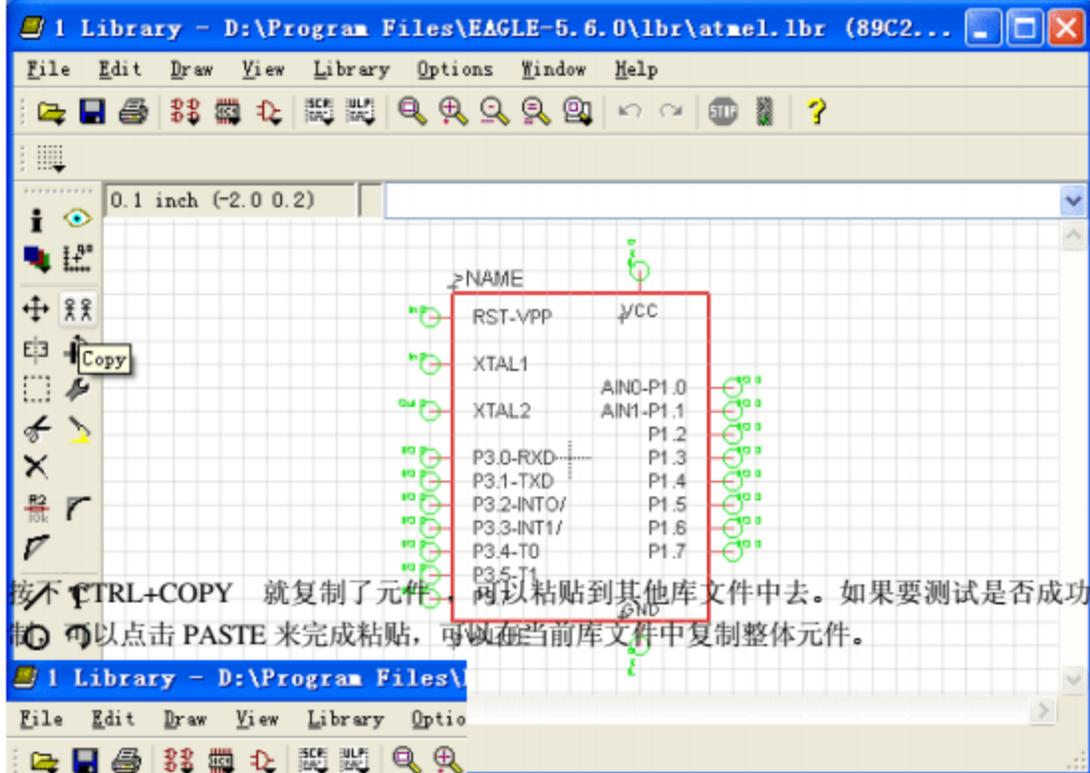
按下 CTRL+COPY 就复制了元件，可以粘贴到其他库文件中去。如果要测试是否成功复制，可以点击 PASTE 来完成粘贴，可以在当前库文件中复制整体元件。
