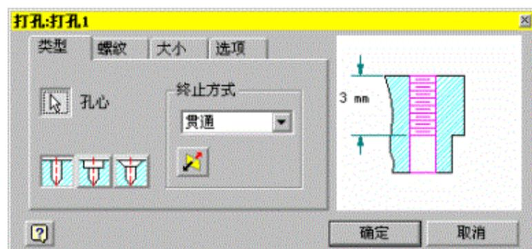
再次选择上平面新建草图，这次直接利用系统自动投影生成的四个圆弧中心作为打孔中心。
