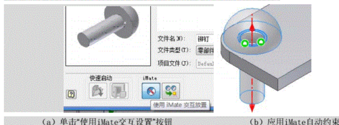
图3-37 在装入零部件时自动使用iMate
