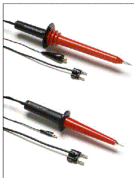
图3. 附件,例如高压探头,用于扩大数字万用表的电压测量范围。
