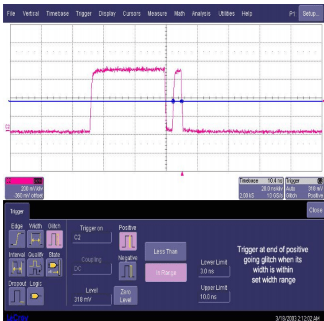
图六 宽度触发应用 间隔触发 ：根据相邻的同极性的沿的时间来触发, 正到正或负到负。设定的条件也可以小于、大于、在范围内或范围外。图七的触发设置含义是：当穿越触发电平的相邻正沿之间的时间间隔在 1.5us 到 2.5us 之间时被触发。图中一定要将触发电平设置为超过欠幅的矮脉冲，否则条件永远不会满足。
