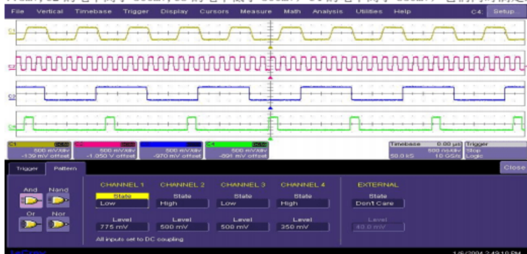
图十 状态触发 逻辑触发 :各通道信号分别同时满足所设定逻辑电平条件及所选择的逻辑关系后触发。可选逻辑条件:与 (And), 非与 (Nand), 或 (Or), 非或 (Nor)。图十一的触发设置含义是: C1 的电平低于 775mV, C2 的电平高于 500mV, C3 的电平低于 500mV, C4 的电平高于 350mV, 它们同时满足这个条
