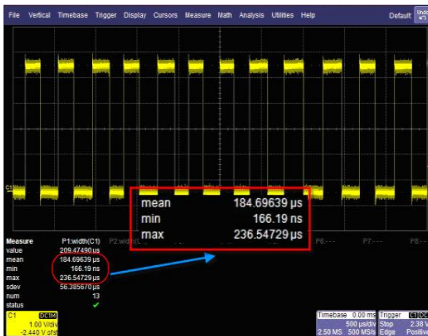
图 2 测量发现被测方波信号脉宽存在异常
