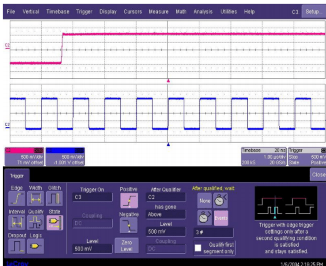
图十 状态触发 逻辑触发 :各通道信号分别同时满足所设定逻辑电平条件及所选择的逻辑关系后触发。可选逻辑条件:与 (And), 非与 (Nand), 或 (Or), 非或 (Nor)。图十一的触发设置含义是: C1 的电平低于 775mV, C2 的电平高于 500mV, C3 的电平低于 500mV, C4 的电平高于 350mV, 它们同时满足这个条
