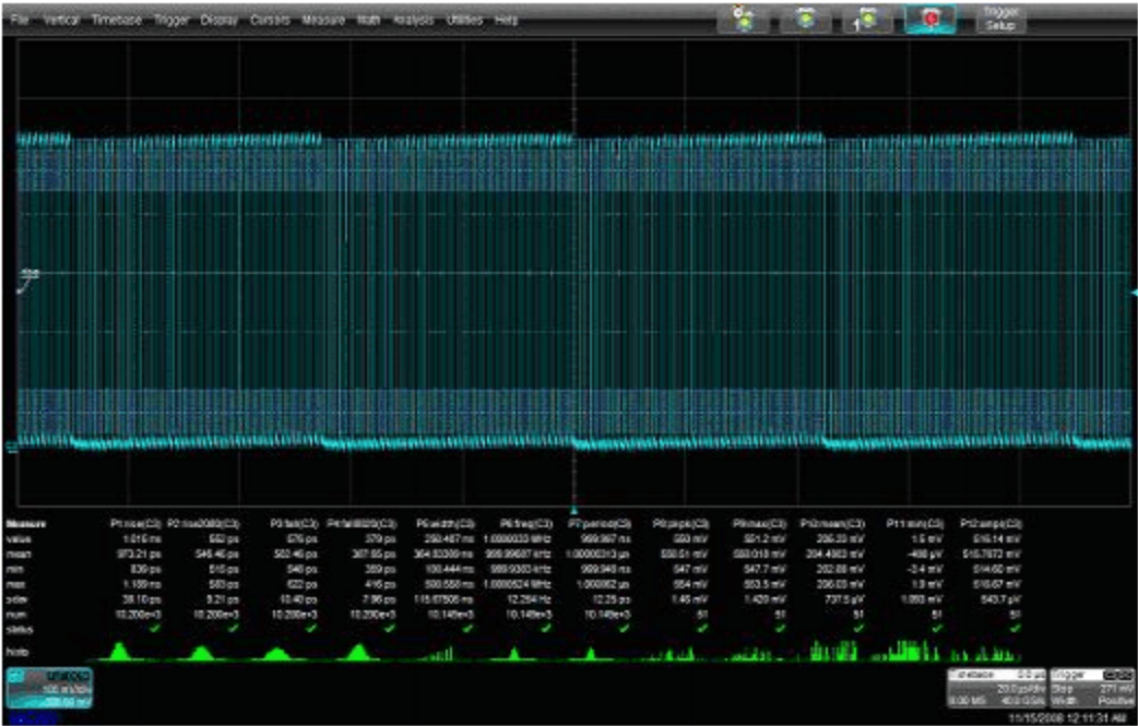
图五 同时测量出 12 个参数并给出了每个参数的小直方图
