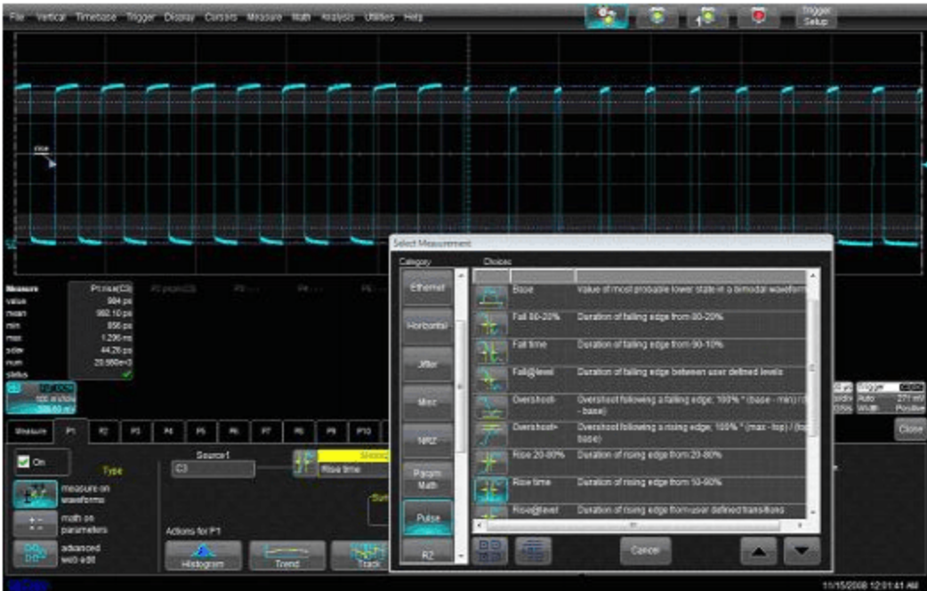
图四 参数列表中的直接说明了参数的含义，光标提供了该参数的形象说明
