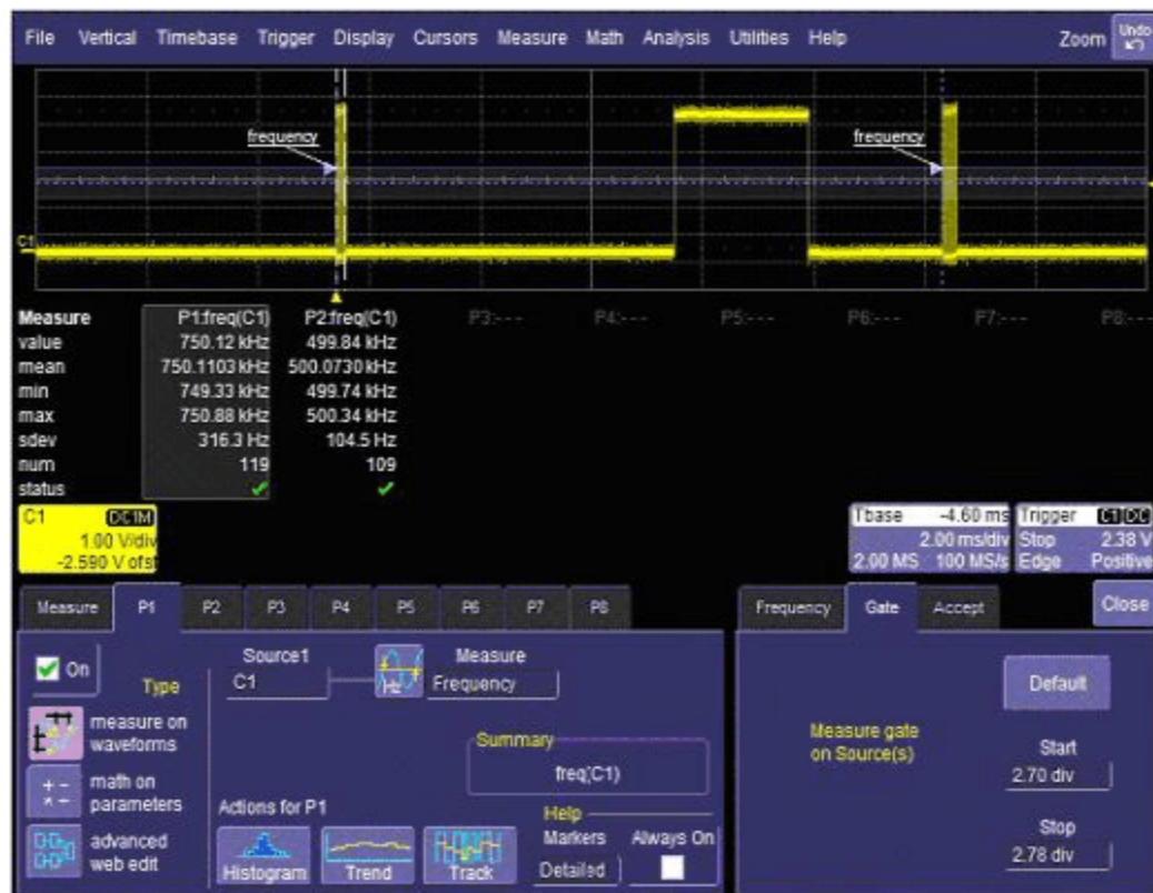
图 13 利用 Gate 功能对限定范围内的波形进行参数测量
