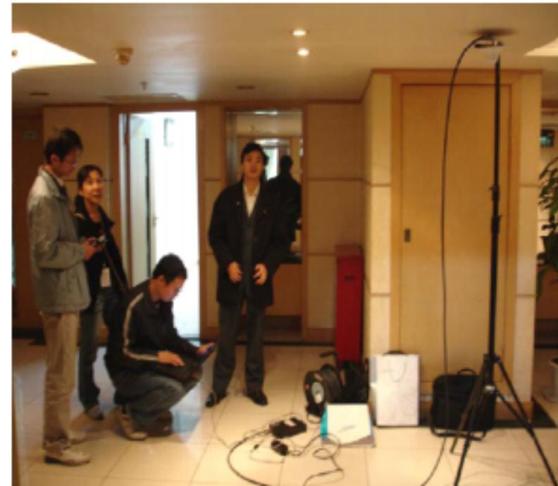
模拟室内天线的发射，测试覆盖效果和天线位置的准确性
