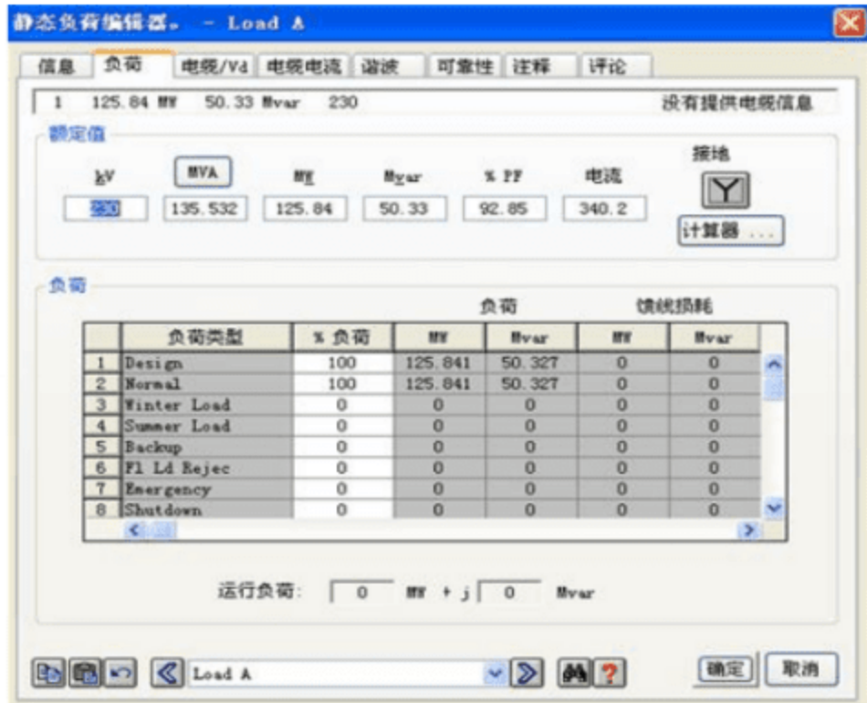
图 2-8 静态负荷 Load A 铭牌页
