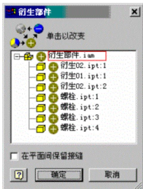
单击对话框中的图标 ，可以使之循环显示为 、、三种符号。
