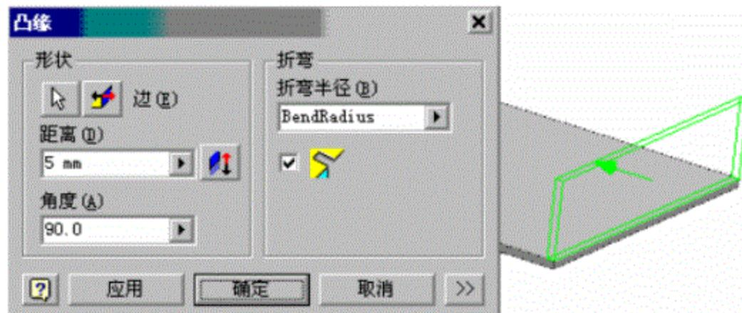
再次单击“凸缘”工具，如下图创建另一条边的凸缘，选择终止方式类型为：宽度。注意选择偏移量的起始点。
