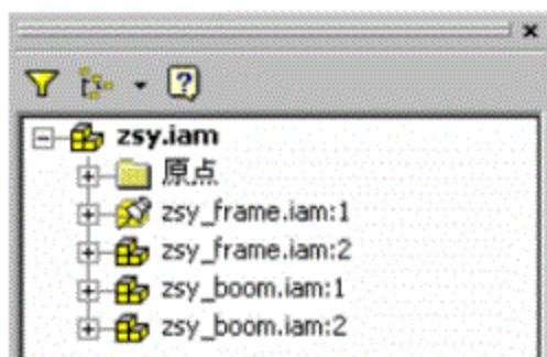
发现本部件是由四个子部件组成的。在添加装配约束的时候，系统将子部件作为一个整体来移动。如果设定了两个机架（`zsy_frame.iam`）之间的角度的话，连接子部件 `zsy_boom.iam` 的当前长度不一定刚好满足装配的需要。实际上，我们通常希望在装配 `zsy_boom.iam` 子部件的时候，其内部零部件的装配位置发生适当的调整，以便改变两端铰点的距离，满足上级部件的装配需要。
