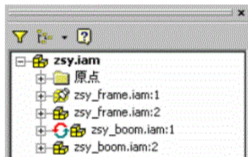
现在，添加轴线配合约束，使 zsy\_boom.iam 连接两边的机架。 zsy\_boom.iam 的装配长度发生变化，如下图：
