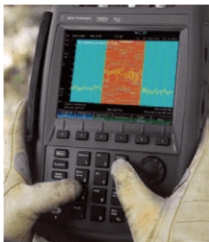
大按钮使用户即便戴着手套也能方便地执行频谱分析测量
