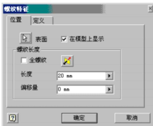
选择在零件的光杆圆柱面上创建螺纹：长度 20mm，系统自动找到适合的螺纹参数：
