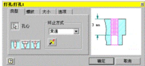
4. 再次选择上平面新建草图，这次直接利用系统自动投影生成的四个圆弧中心作为打孔中心。
