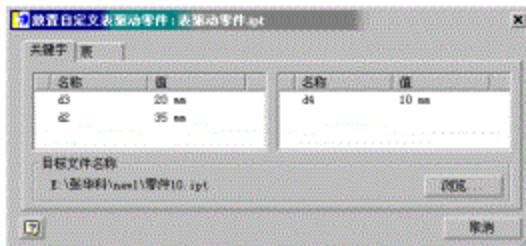
18. 我们可以看到：d4 已经和 d3、d2 分开列出，单击 d4 的值，可以将其改为任意合理的数值，比如 9mm。然后回车，系统将孔径为 9mm 的零件插入部件环境。
