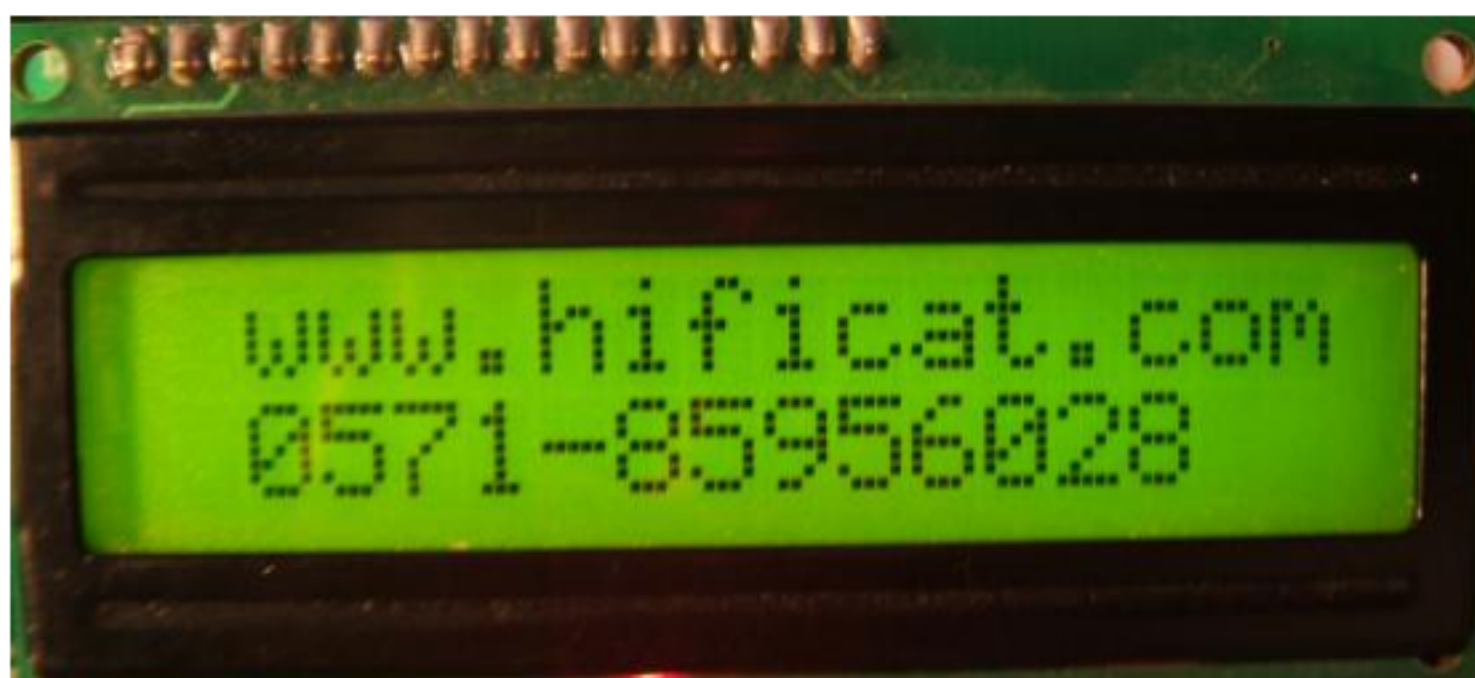
图 10-59 1602LCD 实验演示图
