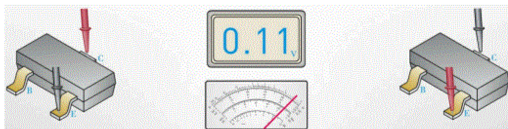
图9.109 两次测试读数都小，CE极击穿短路
