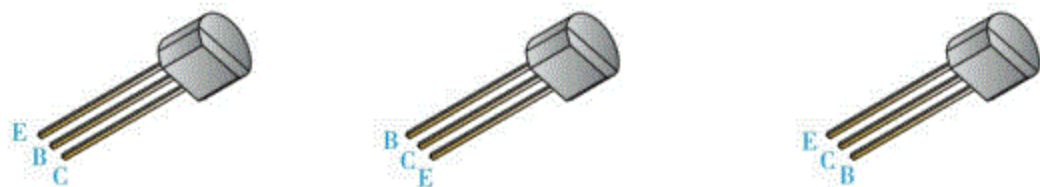
图9.92 TO-92封装的三极管引脚排列示意图
