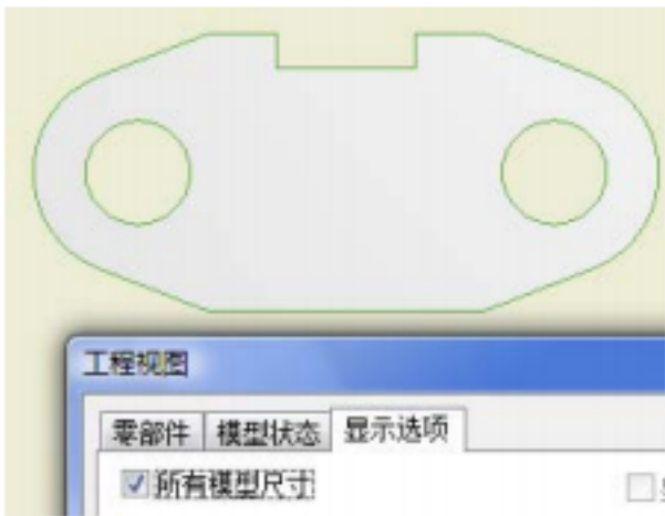
图5-31 创建基础视图时设置模型尺寸
