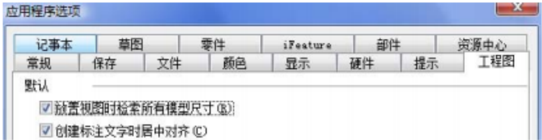
图5-30 在“应用程序选项”卡中设置模型尺寸
