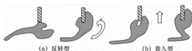
图11 胶套安装时形状的变化
