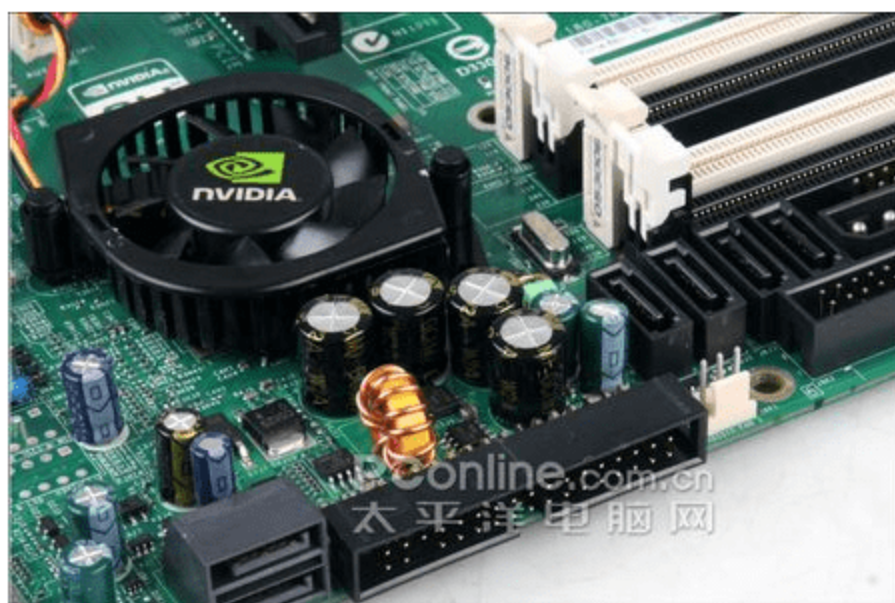
完整的南桥供电模块
