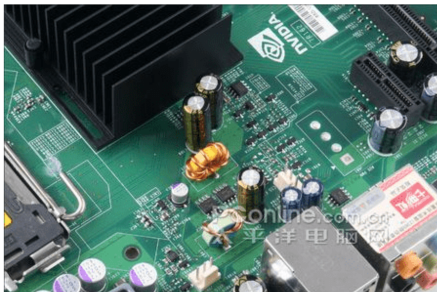
完整的北桥芯片供电模块
