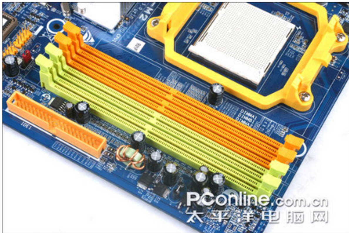
仅配备 1.8V 内存核心供电的电路
