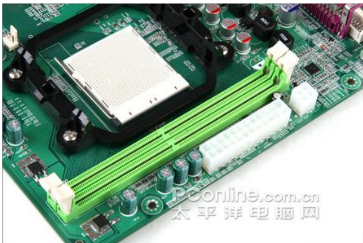
最为简陋的内存供电模块，仅有零星的几个电容和 MOS 管
