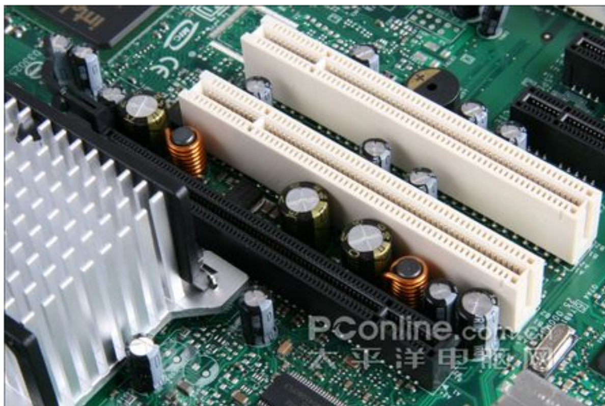
完整显卡供电模块
