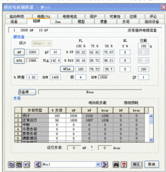
图1-14 感应电动机Mtr1 编辑器的“铭牌”属性页
