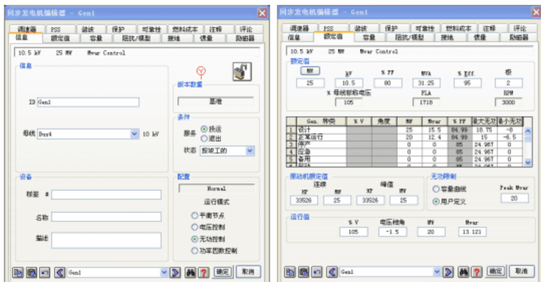
图1-15 同步发电机编辑器的“额定值”属性页
