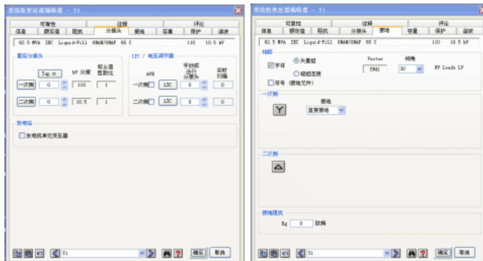
图 1-11 双绕组变压器 T1 编辑器的“分接头”和“接地”属性页
