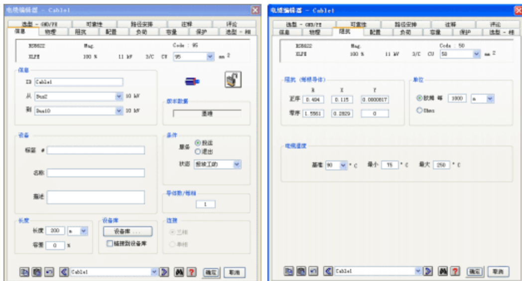
图 1-16 电缆 Cable1 编辑器的“信息”和“阻抗”属性页
