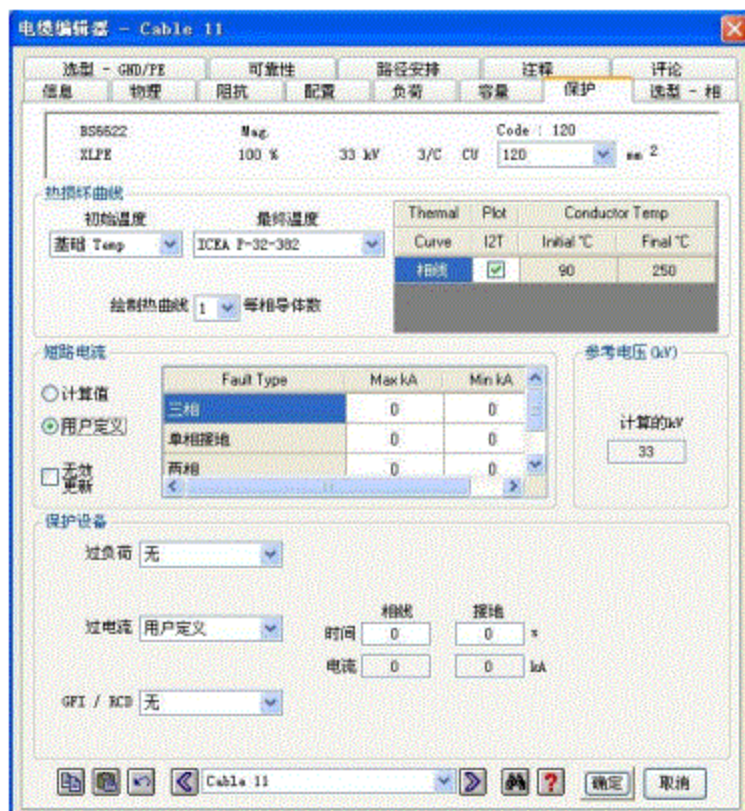
图3-5 电缆编辑器的“选型-相”属性页——根据短路选定尺寸
