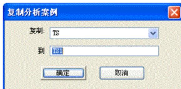
创建一个新的分析案例：进入项目视图，右击电动机起动分析案例文件夹，选择“新建”。所创建的分析案例增加到暂态稳定分析案例文件夹中，是默认分析案例的复制件。
