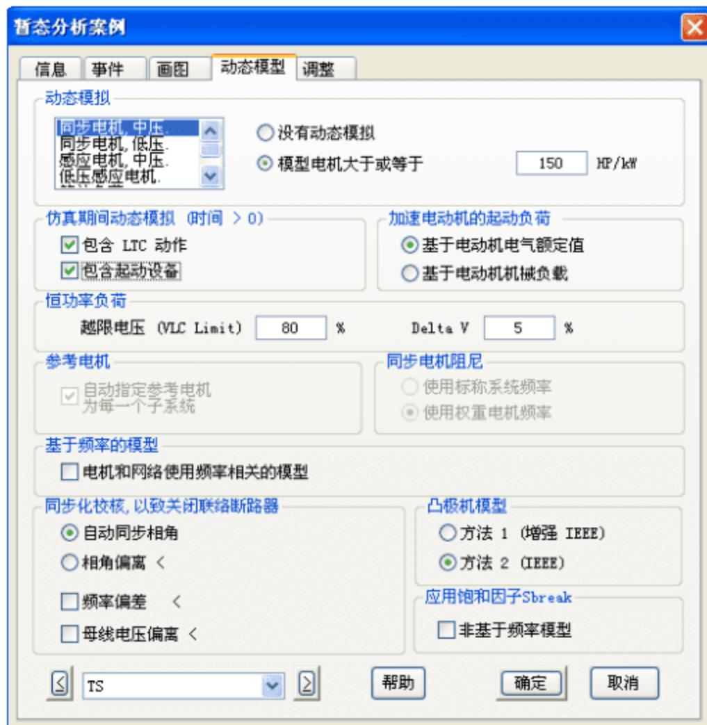
在电机的编辑器中设定了动态模型并且选择总体模拟电机组，电机或者等效负荷就可以进行动态模拟。
