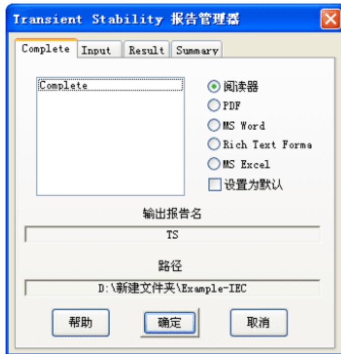
你也可以从位于分析案例工具栏上的输出报告列表框在水晶报告视图格式里选择输出文件。暂态稳定分析的输出报告数据库的扩展名为 .tsr。
