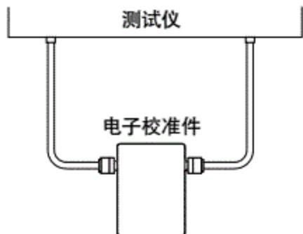
大多数射频、微波元器件都使用非可插入式的连接器, 例如在两个端口上均使用阴性接头连接器的器件。测试这些器件时需要把适配器的影响从校准结果中去掉, 这会给测试结果增加一些不确定因素。大多数先进的矢量网络分析仪使用一种去除适配器影响的技术, 它可以对由于适配器引起的误差进行补偿。
