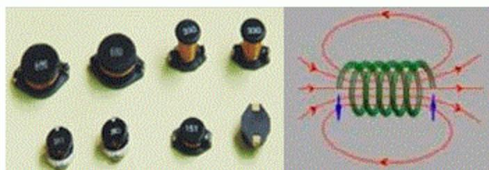
实际应用中，铁氧体材料是作为射频电路的高频衰减器使用的。实际上，铁氧体较好的等效于电阻以及电感的并联，低频下电阻被电感短路，高频下电感阻抗变得相当高，以至于电流全部通过电阻。铁氧体是一个消耗装置，高频能量在上面转化为热能，这是由他的电阻特性决定的。
