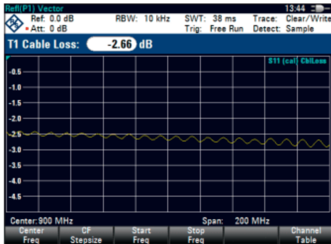
单端口电缆损耗测量。
